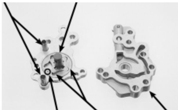
MARCA GRAVADA ROTORES ESPAÇADOR DA BOMBA PINO BASE DA BOMBA
